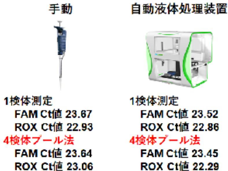
図1 手動と最適化した自動液体処理装置のCt値に及ぼす影響
